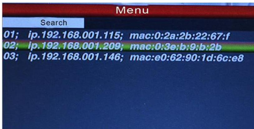
Оператор, передвигая курсор джойстиком вверх-вниз, может выбрать IP адрес необходимого устройства и затем нажать кнопку «Enter» для сохранения устройства и отображения его изображения на дисплее; после получения изображения оператор может управлять PTZ камерой.
