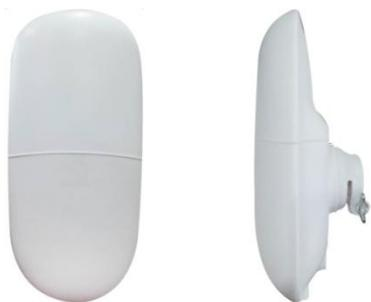
4G/LTE роутер. WiFi 2,4G - 2 Omni антенны по 5dBi, Усиление до 28dBi. 4G - 2 антенны по 5dBi Производительность до 300Mbps. Входы RJ45 LAN и WAN 10/100. Управление через IE11 и Cloud. QoS. MIMO. Питание от passive POE 24V, потребление до 10W (Блок питания входит в комплект). Температурный диапазон -40°C ~ +80°C, IP65, вес 700г, размеры 249x116x97мм. Пластиковый кожух. Комплект для установки на стену и столб.
