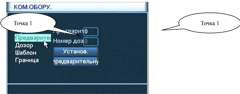
Вызов предустановленной точки. Войдите в интерфейс управления поворотной камерой (PTZ), как показано на Рис. 16. в «Окне ввода значения» введите число предустановленной точки, щелкнуть кнопку «Предустановленная точка». Поворотная камера (PTZ) двигается и встает на предустановленную точку.
