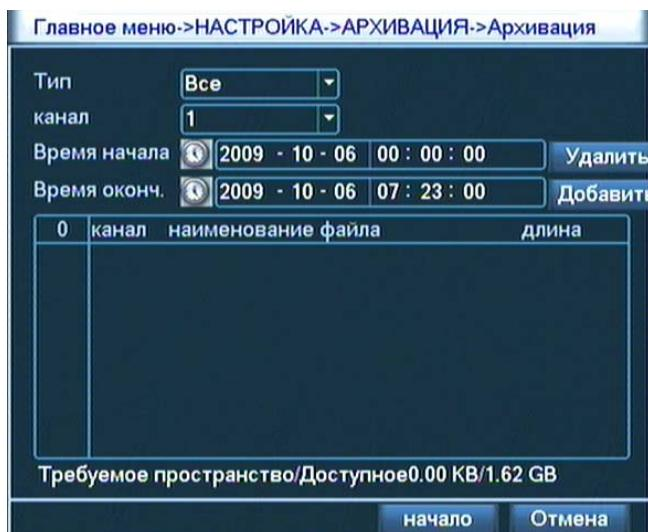
**Начало/стоп:** после выбора файлов, щелкните на кнопку Начало и Стоп для остановки резервного копирования.
