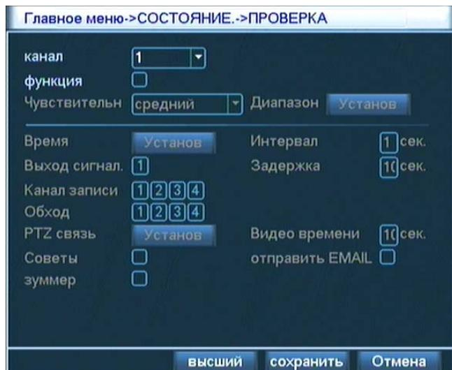
**Рисунок 35. Установка зон детекции движения**
