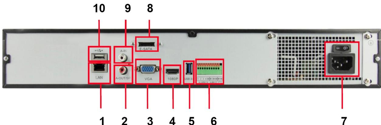
(1) Порт Ethernet (2) Выход аудио (3) VGA выход (4) HDMI (5) Порт USB 3.0 (6) Коммутационная колодка 4Трев. вх./ 1Трев.вых. (7) Разъем питания 220 VAC (8) Разъем подключения E-SATA HDD (9) Аудиовход (10) Порт USB
