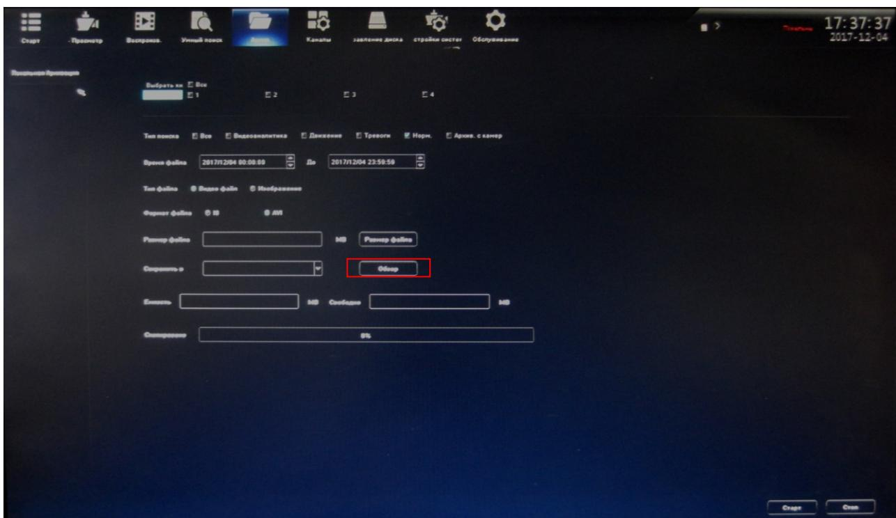
Подключите внешние устройства хранения USB, нажмите **Обзор**, далее нажмите **Обновить** для обнаружения USB устройства. Файлы архивируются в форматах I8 и AVI.
